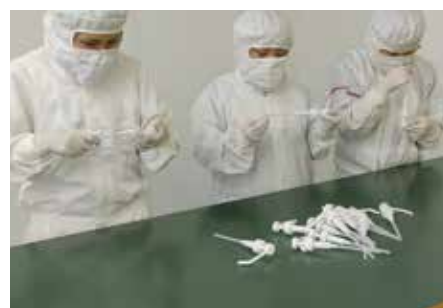
ポンプの外観検査
