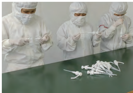
ポンプの外観検査
