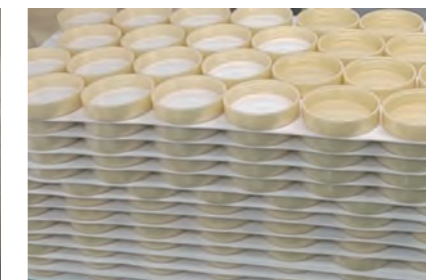
キャップパッキンの貼り付け
